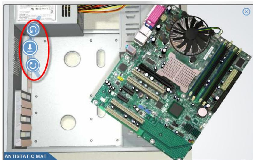
19. Kemudian, pasang *screw* pada motherboard dengan mengklik icon “motherboard screws” dan drag pada lubang *screw* di motherboard.
