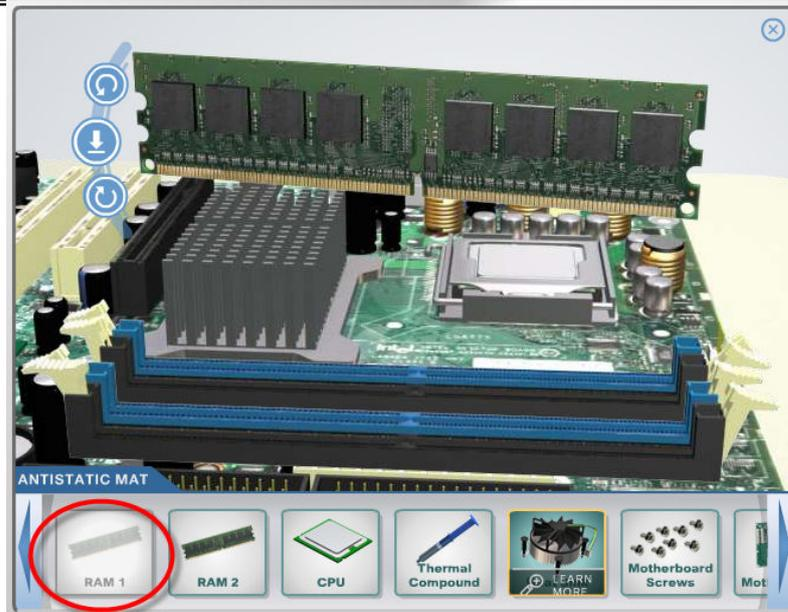
7. Atur posisi RAM sehingga sesuai dengan penempatan pada slot motherboard, kemudian klik tombol “anak panah bawah” untuk pemasangan RAM ke Motherboard.
