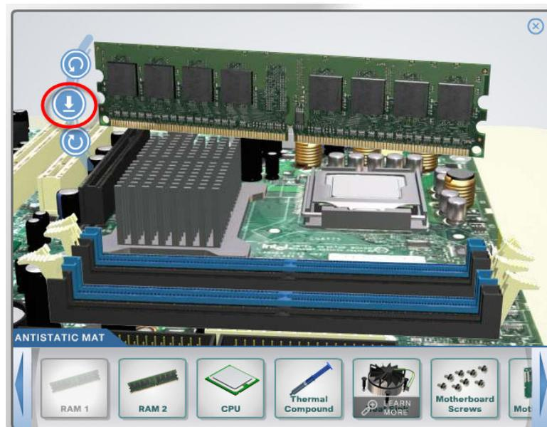
8. Kunci RAM dengan mengklik alat pengaman pada kedua sisi slot RAM.
