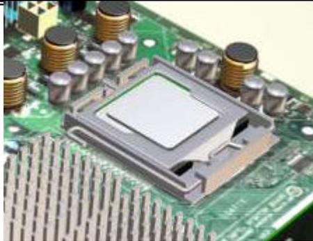
13. Langkah berikutnya adalah mengoleskan *thermal compound* pada permukaan CPU supaya *heatsink* dapat merekat pada CPU. Klik icon “thermal compound” dan drag pada permukaan CPU.
