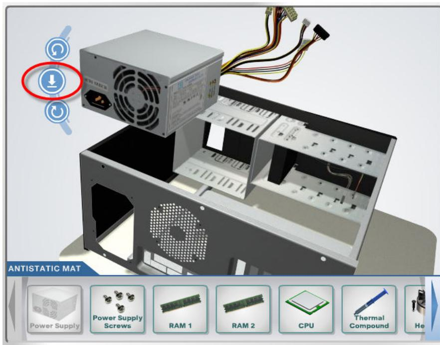
4. Lengkapi pemasangan PSU dengan memasang screw dengan mengklik icon “power supply screw” dan drag ke titik lobang screw antara PSU dan Casing.
